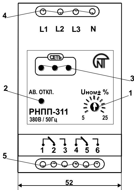
1 – Регулировка срабатывания по  $U_{max}$  /  $U_{min}$ ;
