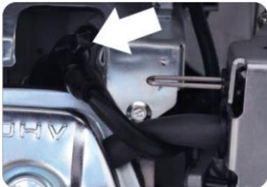
Свеча зажигания: эквивалент TORCH F6TC.
