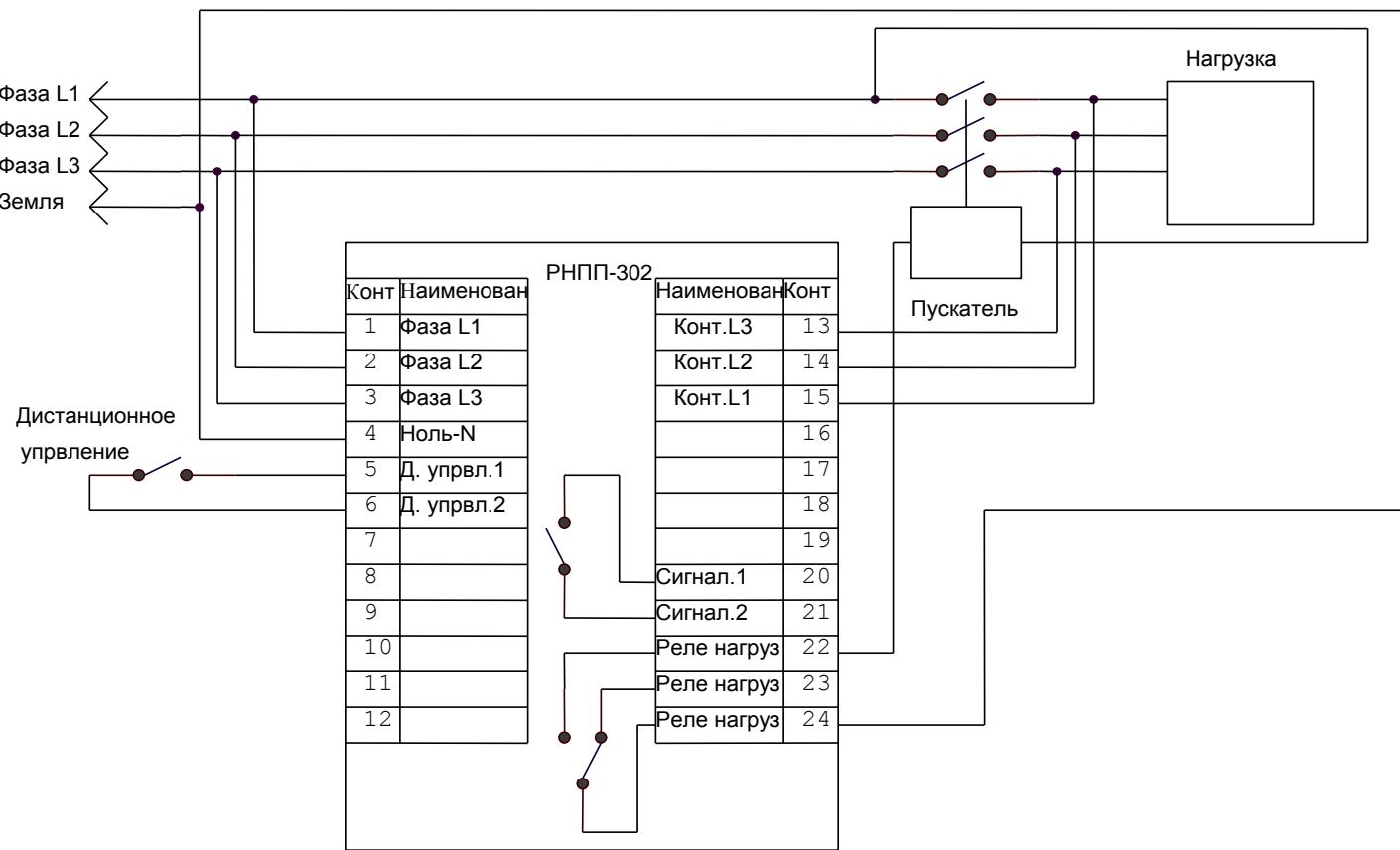
**П р и м е ч а н и е** - При подключении реле в сети с изолированной нейтралью, ноль-N (клемма 4) можно не подключать.
