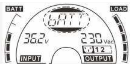
Режим работы от батарей
