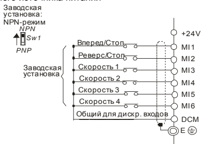
Рисунок 7. Выбор логики управления дискретными входами микропереключателем Sw1.
