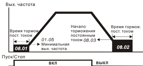
Торможение постоянным током
