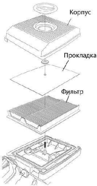
Работа двигателя без воздушного фильтра, с поврежденным или загрязненным воздушным фильтром приведет к тому, что грязь и абразивные частицы с воздухом будут беспрепятственно поступать в двигатель, вызывая быстрый износ двигателя.
