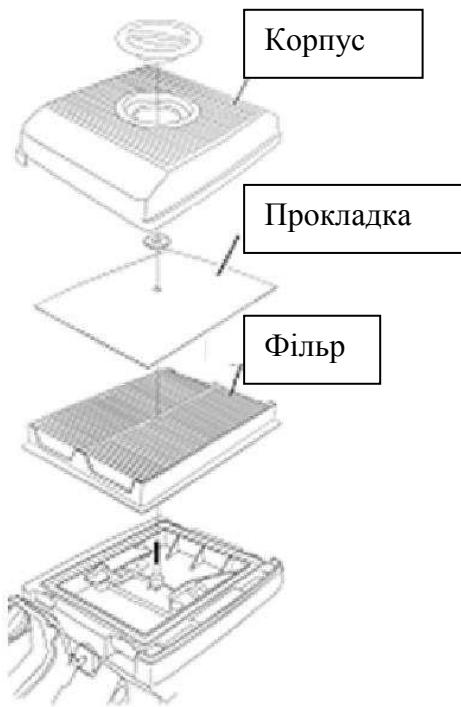
Робота двигуна без повітряного фільтру, з пошкодженим або забрудненим повітряним фільтром приведе до того, що грязь і абразивні частки з повітрям безперешкодно поступатимуть в двигун, викликаючи швидкий знос двигуна.
