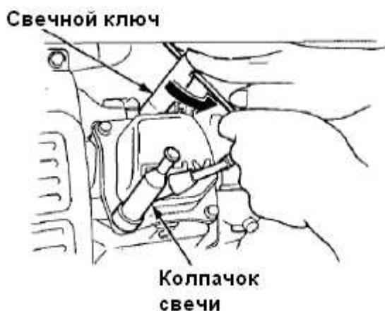
Осмотрите свечу зажигания. Замените ее, если электроды изношены и/или изолятор поврежден или искрошен.
