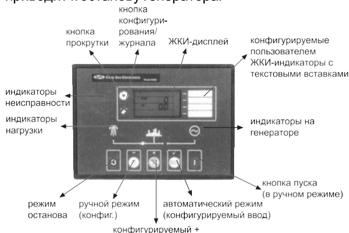
Рис. 17.4 Описание органов управления на панели контроллера DSE 5220
