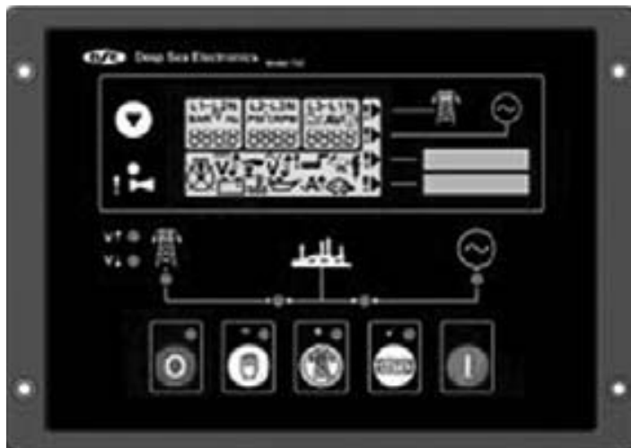
Рис. 20.2 Контроллер DSE 720 AMF
