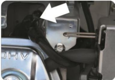
Свеча зажигания: эквивалент TORCH F6TC.
