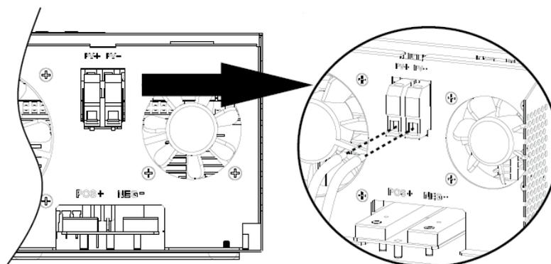
3. Проверить, надежно ли подключены провода.
