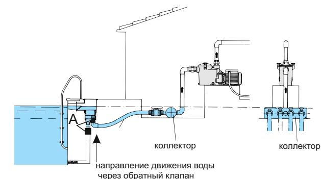
Рис 1.б. Установка с обратным клапаном на рис. обозначен(A) и системой "перелива" воды
