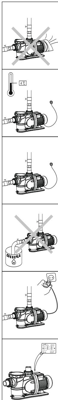
5. Насос должен находиться в вентилируемом помещении, конструкция которого должна предотвращать проникновение атмосферных осадков на корпус и внутрь электродвигателя.
