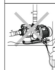
4. Избегайте разбрзгивания воды под давлением в электрический насос, а также не допускайте погружения (даже частичного) электронасоса в воду.
