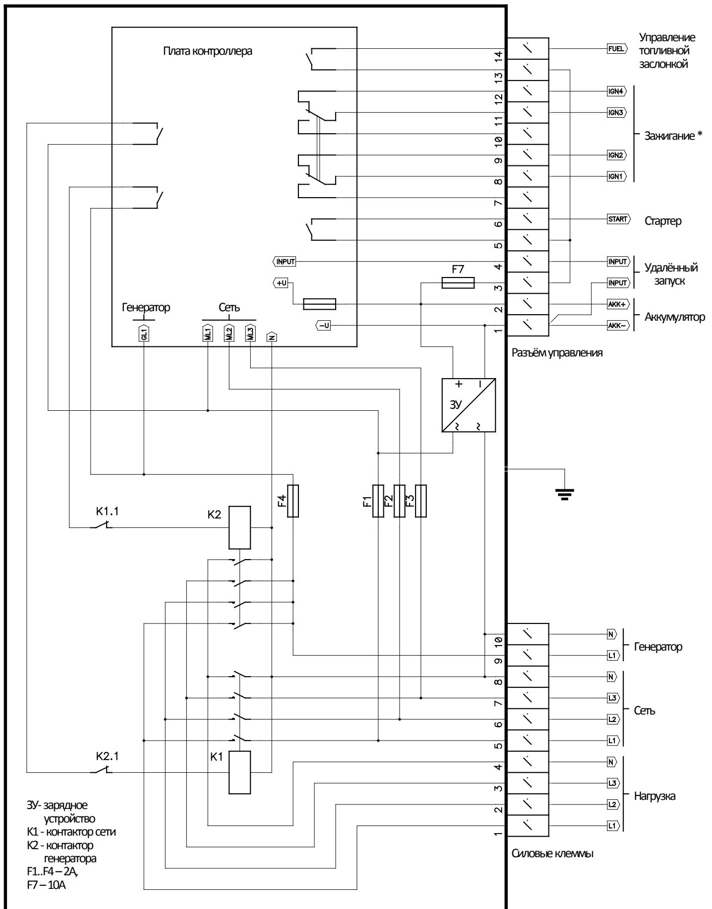
Рис 6.2. Пример схемы подключения контроллера АВР313МЕ.
