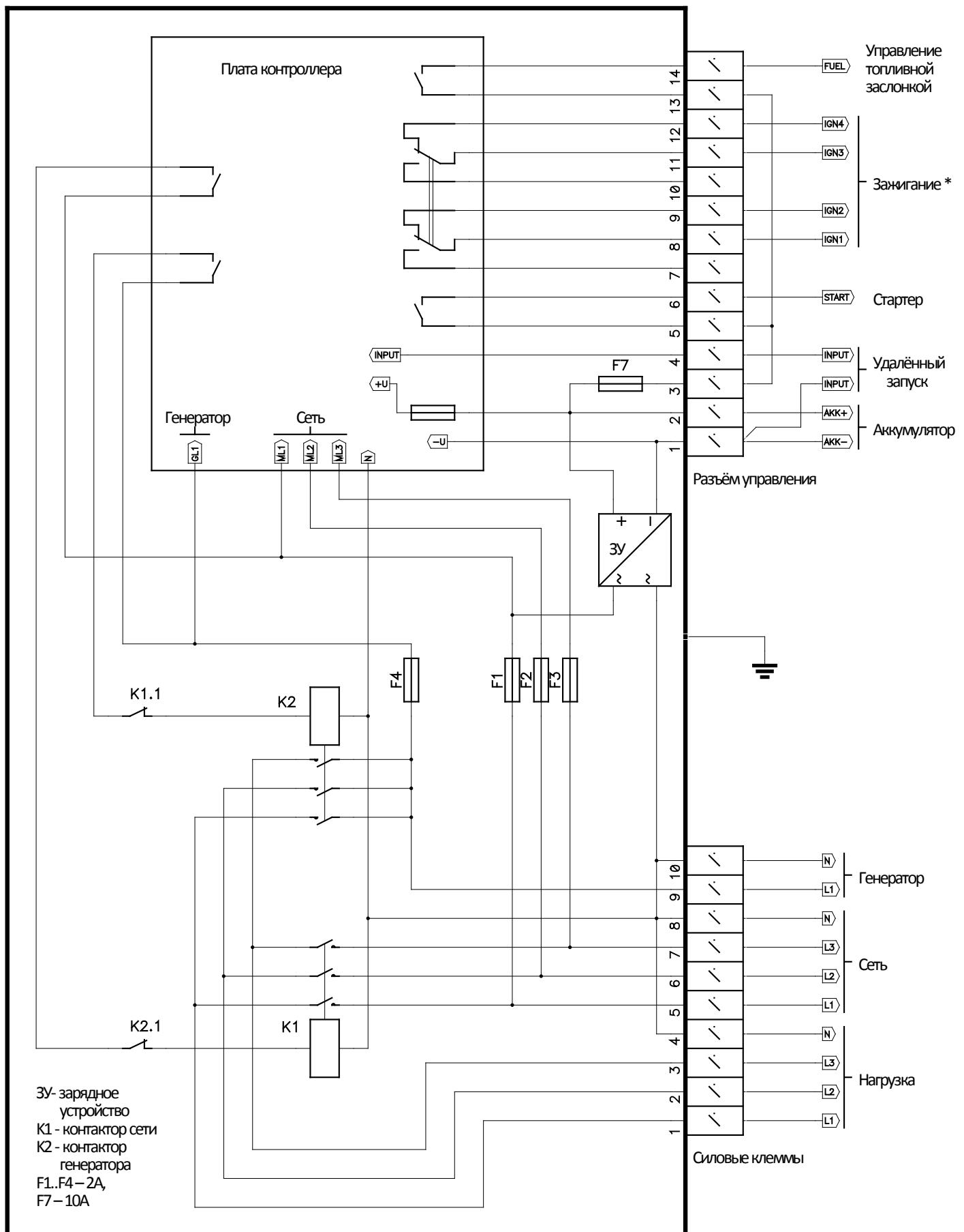
Рис 6.3. Пример схемы подключения контроллера АВР313СЕ.
