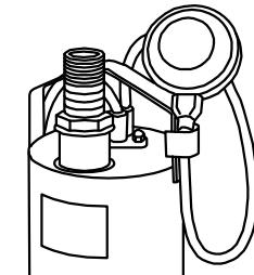
Для этого нужно ослабить клемму (зажим) поплавкового выключателя на ручке насоса. Поднять поплавковый выключатель до ручки,
