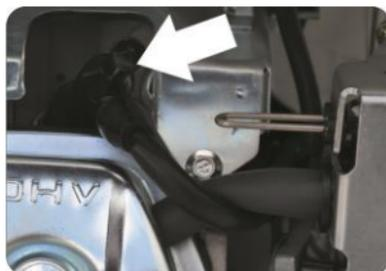
Свеча зажигания: эквивалент TORCH F6TC.
