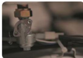
г) Закройте топливный краник - OFF (закрыто).
