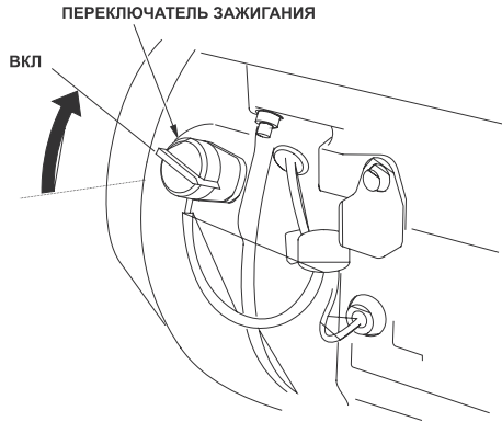
Рис.12 Положение переключателя зажигания при пуске
