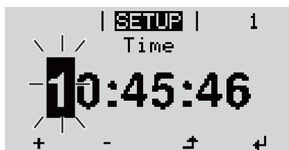
Отобразится текущее время. (ЧЧ:ММ:СС в 24-часовом формате). Цифра, обозначающая десятки в количестве часов, начинает мигать.
