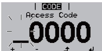
В меню CODE (Код) отобразится раздел Access Code (Код доступа), при этом первая цифра кода начнет мигать.
