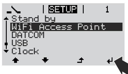
В инверторе начинает работать точка доступа WiFi. Точка доступа будет активной в течение 1 ч. Переключатель IP на устройстве Fronius Datamanager 2.0 может оставаться в положении А благодаря подключению к точке доступа WiFi.
