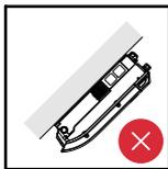
Не устанавливайте инвертор таким образом, чтобы он нависал, а разъемы были направлены вверх.
