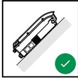
Инвертор подходит для установки на наклонной поверхности.
