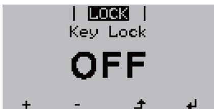
В меню LOCK (Блокировка) отобразится раздел Setup Menu Lock (Блокировка меню настройки).
