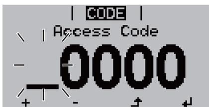
В меню CODE (Код) отобразится раздел Access Code (Код доступа), при этом первая цифра кода начнет мигать.
