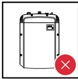
Не устанавливайте инвертор на вертикальной стене или стойке так, чтобы его разъемы были направлены вверх.
