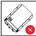
Не устанавливайте инвертор под наклоном на вертикальной стене или стойке.
