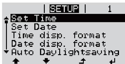
Введенное время устанавливается в устройстве. Отображается перечень параметров, которые можно изменить.
