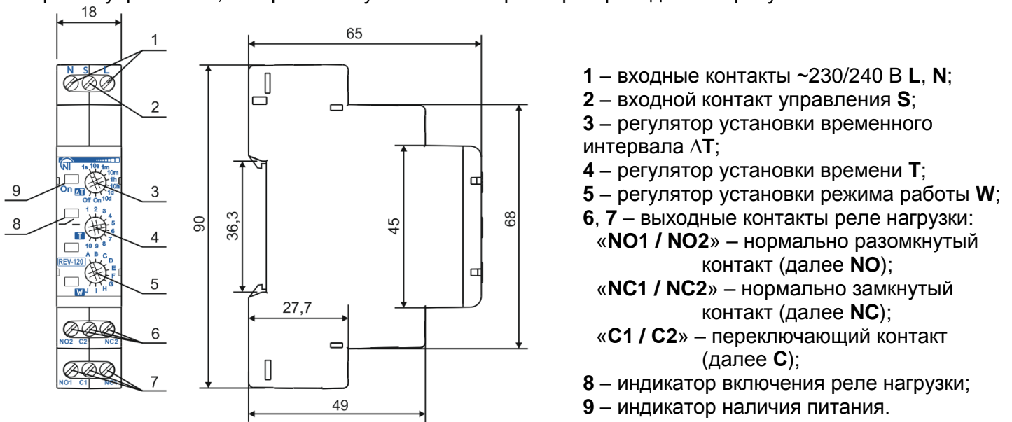
Рисунок 1 – Органы управления, габаритные и установочные размеры REV-120
