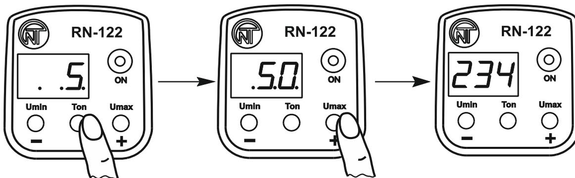
Нажмите кнопку **Ton** – на дисплее отобразится заводская установка параметра с мигающими точками (**.5.**)
