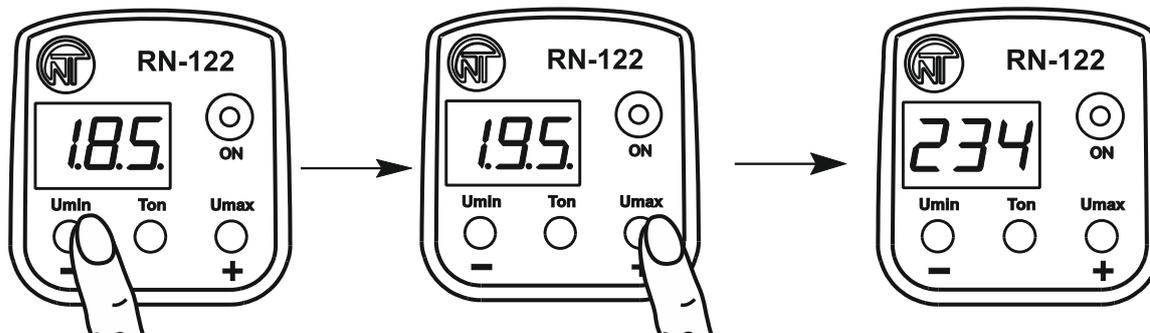
Нажать кнопку **Umin/-** – на дисплее отобразится заводская установка параметра с мигающими точками (18.5.)
