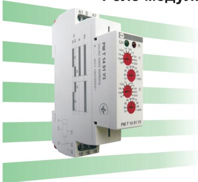
Реле модульні циклічного включення з одним (РМ Т 14 51) або двома (РМ Т 14 52) перемикаючими контактами. Час роботи та паузи встановлюється окремо від 0.1 секунди до 100 діб. Можуть використовуватися для циклічного включення вентиляторів, нагрівачів, освітлення, тощо.
