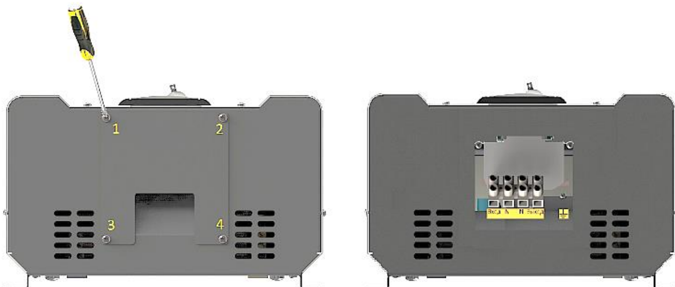
Рисунок 12. Схема зняття захисної кришки знизу корпусу стабілізатора
