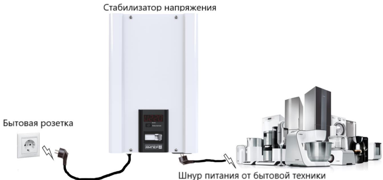
Рисунок 13. Подключение стабилизатора к сети
