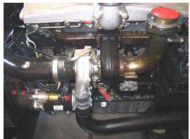
Рис.2 Вихлопна система і зовнішня поверхня двигуна
