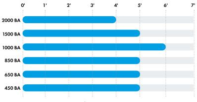
Внутренняя аккумуляторная батарея, нагрузка 50 %
