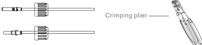
Малюнок. 3.4 Обтисніть контактний штифт до дроту
